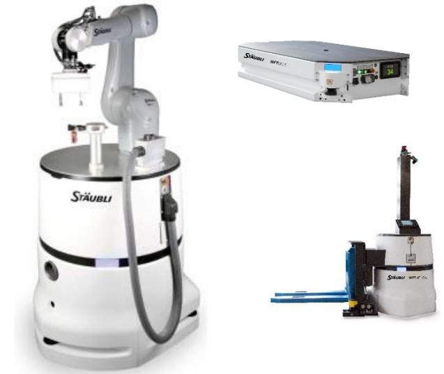
Ils sont capables de se déplacer dans un environnement et d'être équipé ou non d'un manipulateur.
