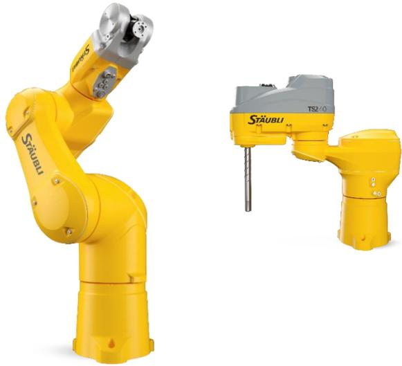
Officiellement défini comme un contrôle automatique, reprogrammable, manipulateur dans trois ou plusieurs axes.
