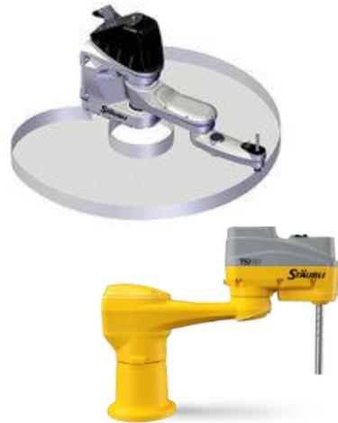
Robots qui ont deux joints rotatifs parallèles pour assurer la conformité dans un plan.
