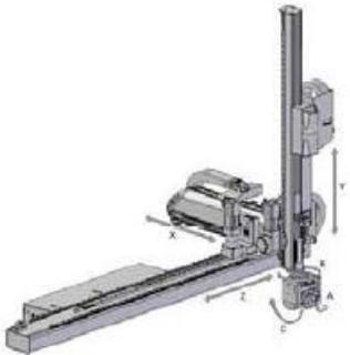
Robots dont le bras comporte trois articulations prismatiques et dont les axes sont corrélés avec un système de coordonnées cartésiennes.
