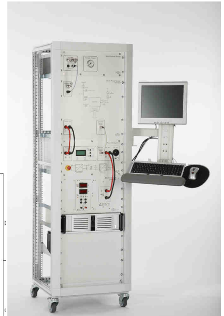
Pile à Hydrogène 1 200 W, alimentation de secours de salle informatique. Contrôle/commande par PC intégré permettant une étude détaillée de l'ensemble
