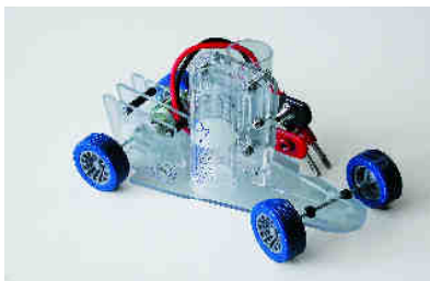
Véhicule électrique animé par une pile H2 réversible
