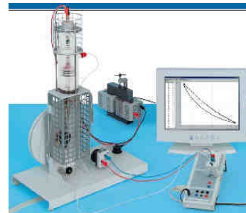
Thermodynamique : Diagramme PV du moteur de Stirling
