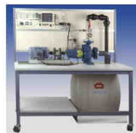
Moteur électrique triphasé à vitesse variable, 1.5 kW entraînant une pompe à eau de station de système d'irrigation
