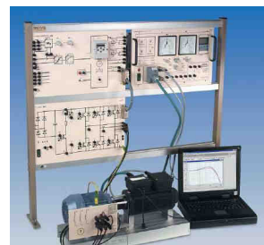
Électronique de puissance et banc d'essais de machines de 300W à 1.5kW
