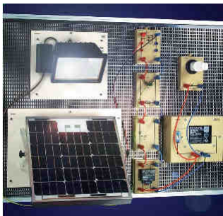
Étude du capteur photo voltaïque et de l'électronique associée pour réaliser une alimentation de secours
